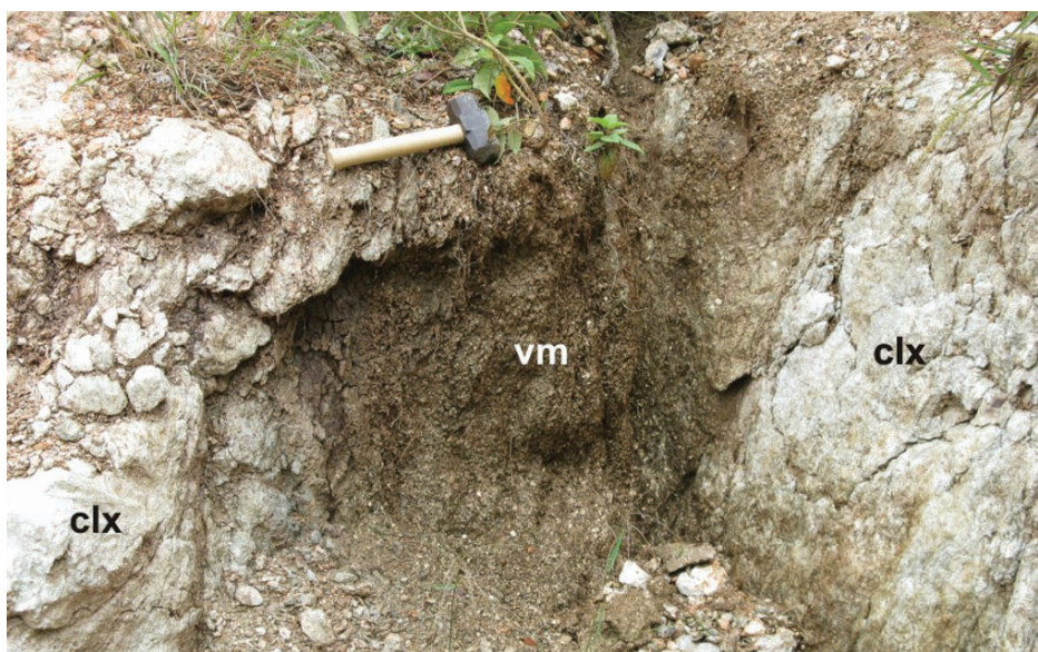
Foto 9 – Exposição do veio de vermiculita (vm), encaixado em cloritaxisto (clx), no garimpo de coríndon do Vadu
