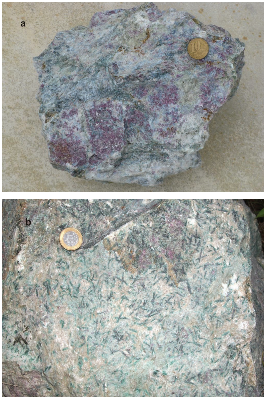
Foto 10 (a, b) – Amostras representativas do minério de coríndon no garimpo do Vadu. O coríndon vermelho-arroxeadado forma massas granulares, enquanto que o de cor verde apresenta-se em cristais alongados, idiomórficos
