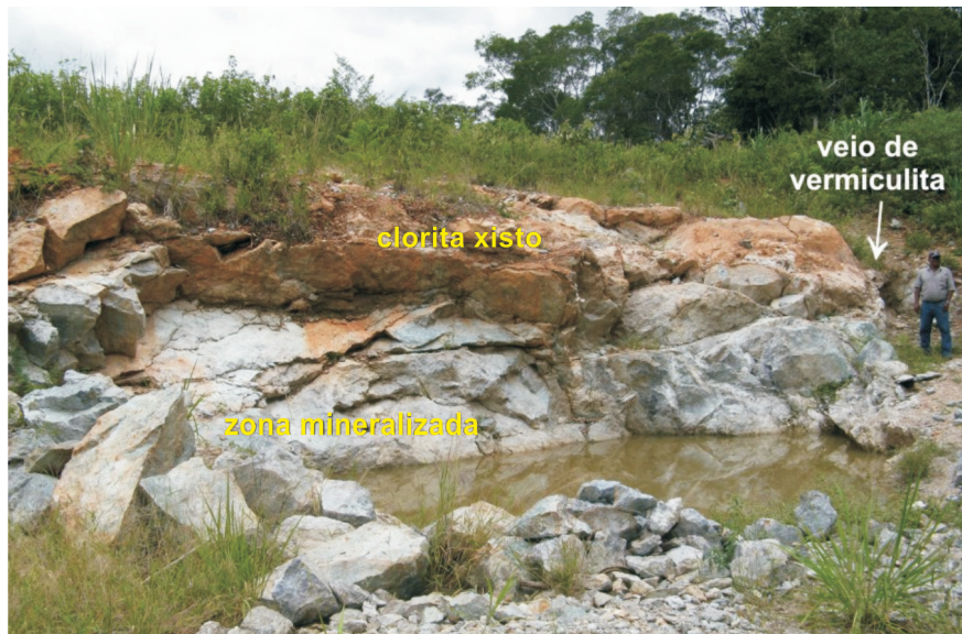
Foto 8 – Vista da frente de lavra de coríndon do garimpo do Vadu, área de Mundo Novo. A mineralização está encaixada em cloritaxisto e na extremidade da cava ocorre um veio de vermiculita
